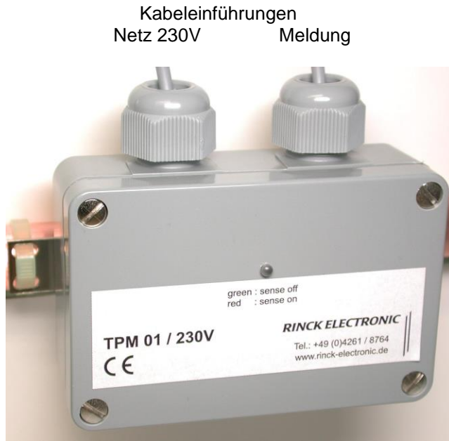
TPM 01/230V Vor der Montage das Schutzpapier der Thermoleitfolie an der Rückseite des Trägerblechs abziehen!
